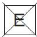
شکل ۲-۴-۳- لامپ برای عملکرد اضطراری مناسب نیست
